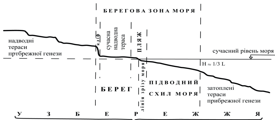
Рис. 1. Двомірна графічна схема узбережжя морів та океанів у вигляді поперечного профілю (Шуйський, 2020).
