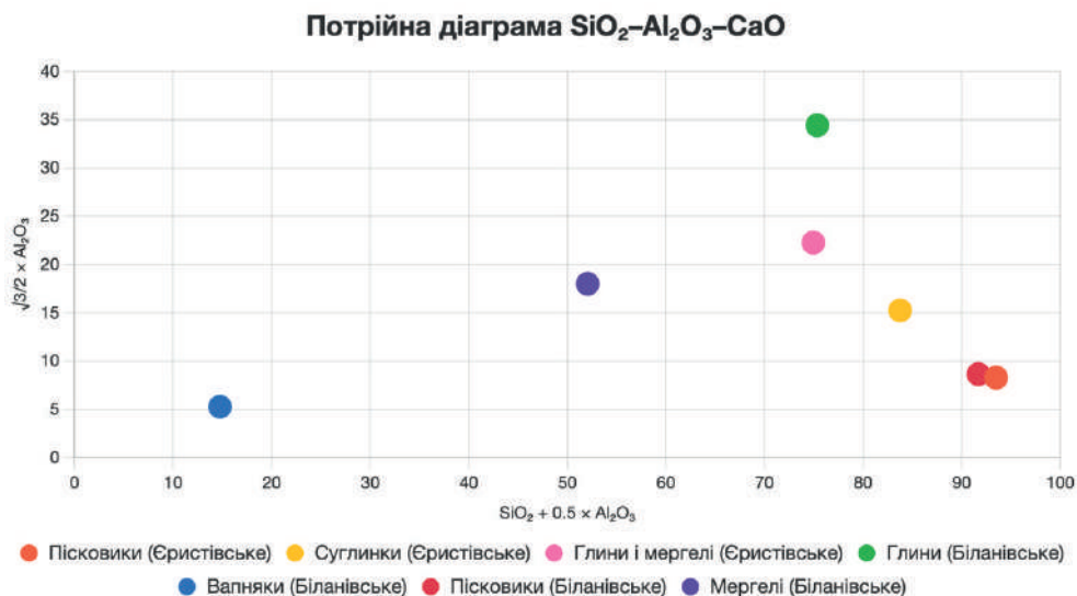
Рис. 4. Геохімічні діаграми. Потрійні діаграми ( SiO_2-Al_2O_3-CaO ) для порівняння геохімічного складу пісковику, суглинку, глини, мергелю і вапняку обох родовищ.
