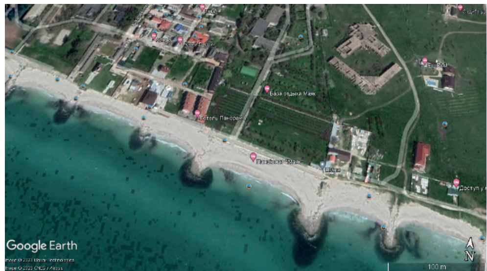
Рис. 8. Берег в межах лобовища прибережно-морської «системи Тендра – Джарилгач», який цілком забудований та розрахований на закріплення від деструкції за допомогою коротких кам'яно-накидних бун (показані 6 міжбунних «кишень»). Східний фланг селища Залізний Порт, влітку 2023 р.
