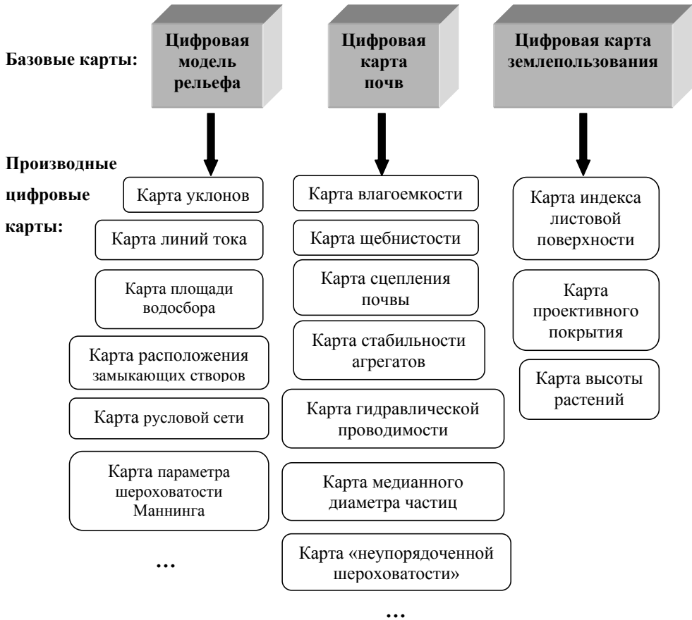
Рис. 2. Структура банка данных пространственного эрозионного моделирования
