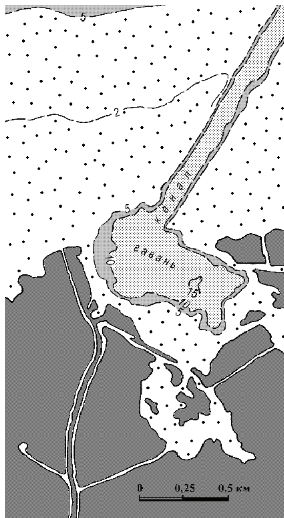
Рис. 10. Антропогенное преобразование дна Жебриянской бухты путем создания ковша гавани и подходного канала к порту Усть-Дунайск (схема 1992 года). Темная заливка – поверхность дельтового конуса
