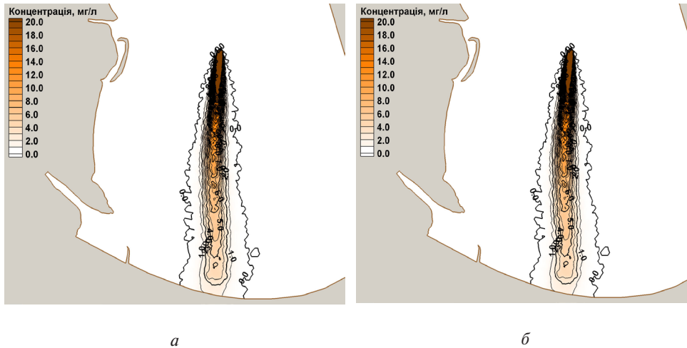
Рис. 4. Результаты числового моделювання розподілення концентрацій взвешенних наносів (мг/л) в поверхневому (а) і придонному (б) слоях при неперервному сбросе грунтовой массы на отвал (по данным [9]).
