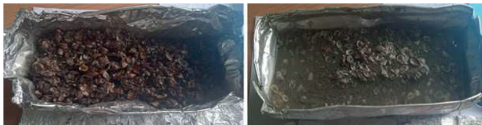
Рис. 1. Порівняння складу матриці проб донних відкладів тотожного літологічного складу, відібраних Ван-Він грабом (зліва) та мультикорером (справа). Шельф Румунії (рейс DOORS, MN240, 2023)
