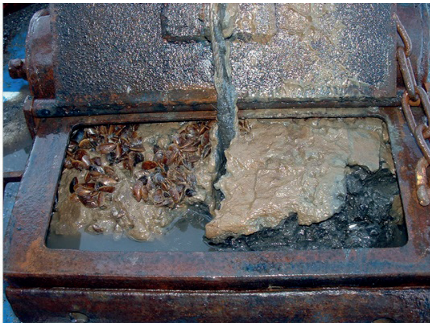
Рис. 1. Ознаки замулення в донних відкладеннях
